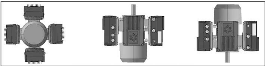
Abb.: 9 Motoreinbaulage / Zulässige Ausrichtung
